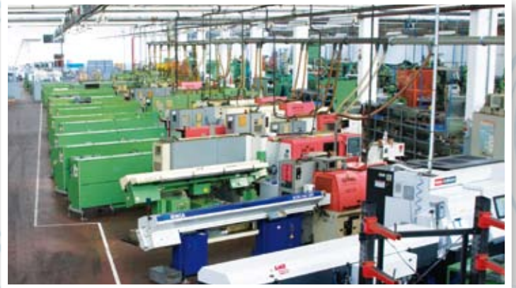
Сан-Маурицио-д'Опальо. Вид на производственный отдел с многошпиндельными и CNC-станками.
