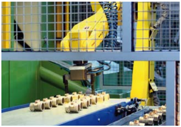
Деталь автоматизированной погрузки на станочную линию
